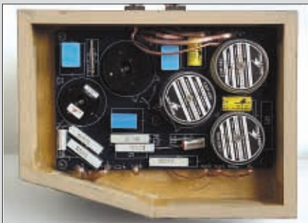
Il filtro montato nella parte inferiore dello zoccolo
